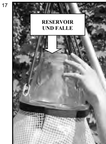
Schieben Sie die Falle und Reservoir in den Ring und befestigen Sie den Aufhängegummi mit dem D-Verschluss wieder am Ring. Befestigen Sie die Winddichtung für zusätzliche Festigkeit und Windbeständigkeit.
