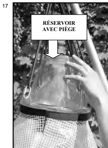
Faites glisser le piège avec le réservoir attaché dans l'anneau et fixez à nouveau le caoutchouc de suspension à la manille lyre. Maintenant, fixez le joint de vent pour plus de solidité et de résistance au vent.
